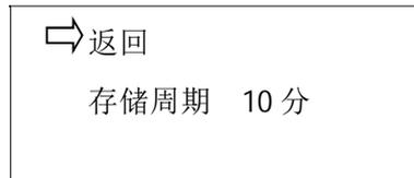
光标选择存储周期，用
